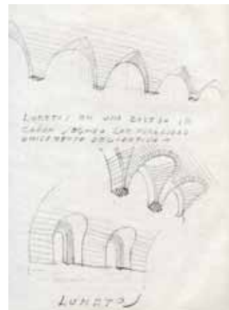
→ Dibujo elaborado por Montoya Valenzuela, en su cuaderno de apuntes de clase, donde se destacan los diferentes tipos de aparejos que usualmente utilizaba en sus anteproyectos. Colección Francisco Montoya Orozco.
